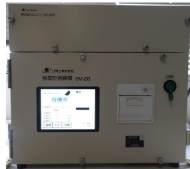
強震計測装置
